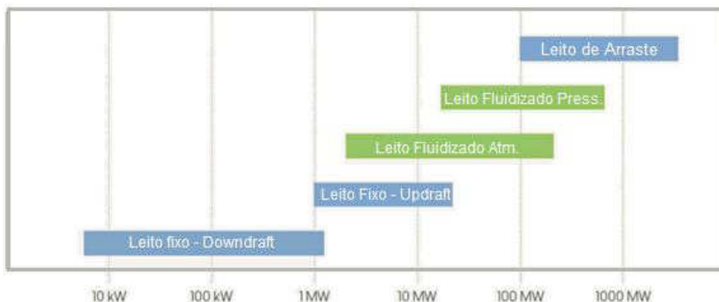
Figura 21 – Classificação dos Gaseificadores por Tamanho.
