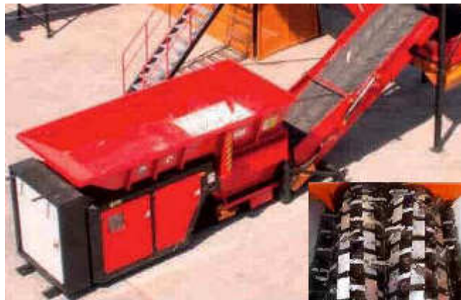
Figura 42 – Processo de Trituração < 50 mm do RSU.
