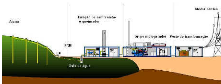
Figura 12 – Captação do metano em aterros sanitários.
